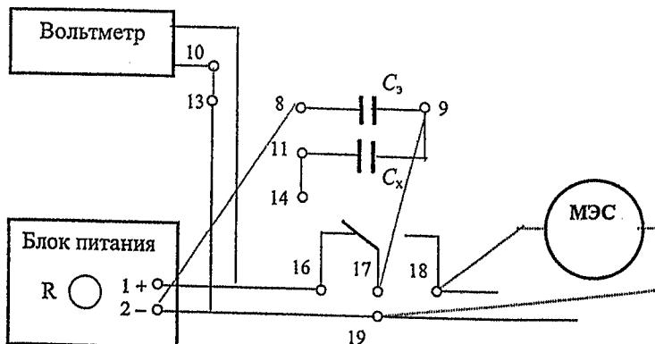
Переведя тумблер в левое положение, зарядить конденсатор в течение 3-х секунд и разрядить его переводом тумблера вправо. Подобрать напряжение  $U$ , при котором стрелка амперметра отклоняется на наибольшее число делений  $\alpha$  равномерной шкалы прибора, и измерить зависимость  $\alpha(U)$  для пяти приблизительно равноотстоящих значений  $U$ . Данные занести в таблицу.
