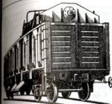
Рис. 4.24. Накладной вибратор для выгрузки сыпучих грузов и очистки полувагонов
