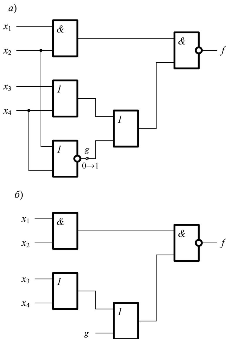
Рис. 4 Неисправность внутренней линии  $g$
