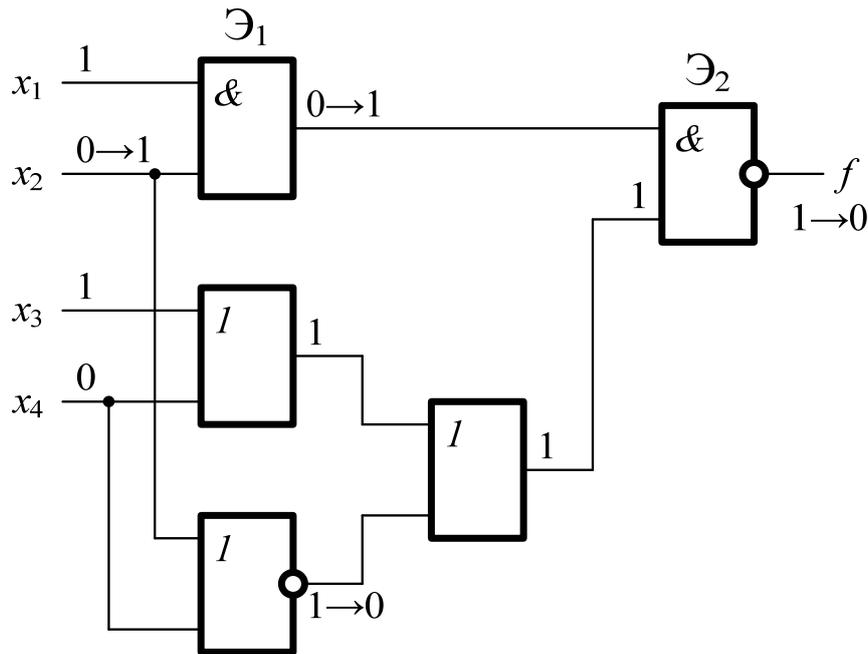
Рис. 3 Пример трансляции ошибки со входа  $x_2$  при подаче на входы набора  $\langle 1010 \rangle$
