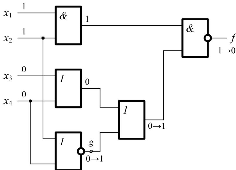
Рис. 5 Трансляция неисправности на линии  $g$  на вход схемы при подаче тестового набора
