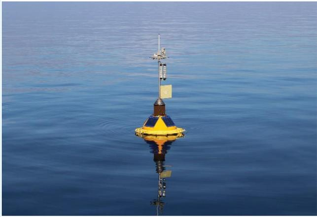
Буй «Амнис» предназначен для изучения поверхностных и глубинных течений, гидрометеорологического и экологического мониторинга и многого другого. Эта разработка полезна как для научных институтов в проведении исследований, так и для фирм, проводящих проектные работы при постройке буровых платформ, добыче нефти, газа и других природных ископаемых.
