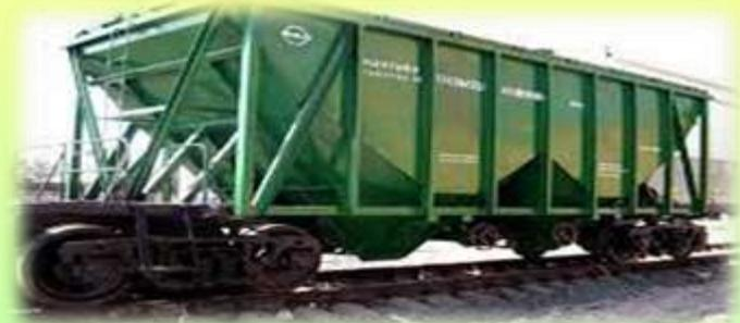
Хоппер — саморазгружающийся бункерный грузовой вагон для перевозки массовых сыпучих грузов: угля, руды, цемента, песка, зерна, торфа, балласта.
