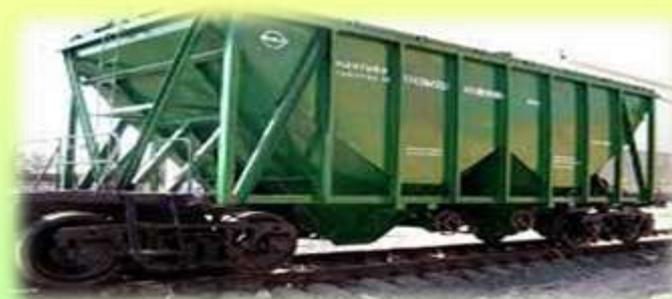
Хóппер — саморазгружающийся бункерный грузовой вагон для перевозки массовых сыпучих грузов: угля, руды, цемента, песка, зерна, торфа, балласта.
