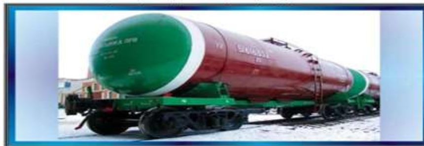
**цистерны предназначены для перевозки для жидкых, газообразных и пылевидных грузов**
