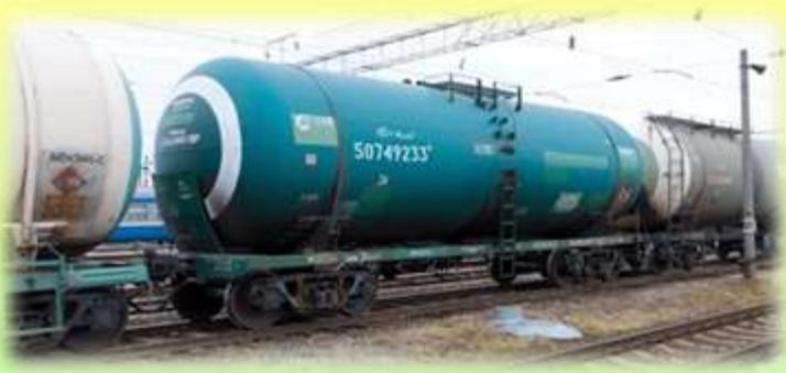
**Вагон-цистерна — вид подвижного состава железных дорог для перевозки жидкостей, в том числе: нефти и продуктов её переработки, химически активных и агрессивных жидкых веществ (кислоты, щёлочи и др.), сжиженного газа (пропан-бутан, кислород), пищевых продуктов (вода, патока, вино, растительные масла) и др. Вагоны-цистерны используются также для перевозки мелкодисперсных порошков: муки (муковоз), цемента, талька и прочего.**
