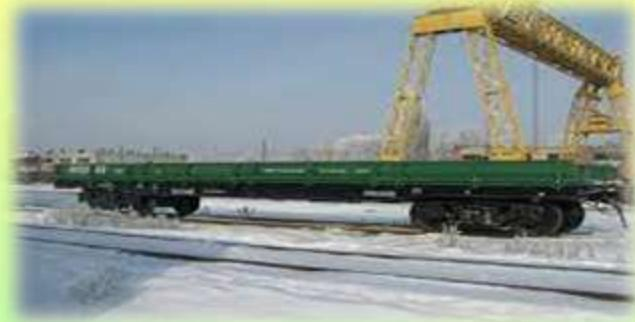
**Платформа — грузовой вагон открытого типа, предназначенный для перевозки длинномерных, штучных грузов, контейнеров и оборудования, не требующих защиты от атмосферных воздействий.**
