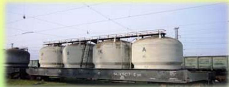
Вагон бункерного типа — крытый грузовой вагон для перевозки грузов (сыпучих: мука, зерно, цемент, негашёная известь, щебень, неагрессивных нефтепродуктов: вязкий нефтебитум и нефтяной кокс), снабженный бункером — ёмкостью для груза и бункерным устройством, позволяющим загружать и разгружать груз без ориентирования — «навалом».
