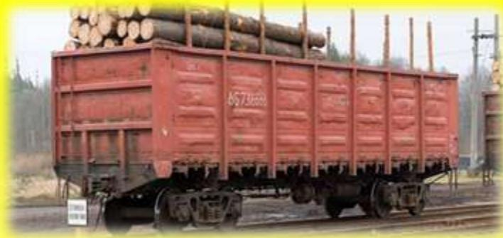
**Полувагон — железнодорожный грузовой вагон с кузовом без крыши, предназначенный для перевозки грузов, не требующих защиты от атмосферных осадков.**
