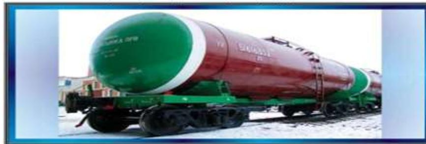
цистерны предназначены для перевозки для жидких, газообразных и пылевидных грузов
