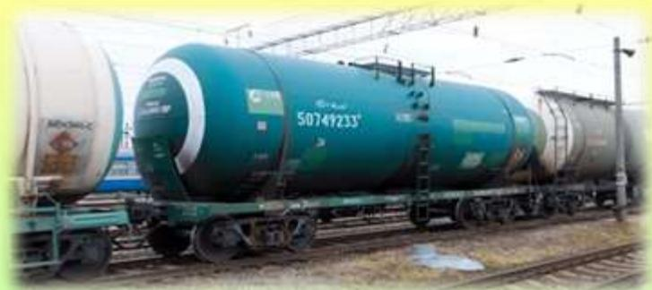
**Вагон-цистерна — вид подвижного состава железных дорог для перевозки жидкостей, в том числе: нефти и продуктов её переработки, химически активных и агрессивных жидких веществ (кислоты, щёлочи и др.), сжиженного газа (пропан-бутан, кислород), пищевых продуктов (вода, патока, вино, растительные масла) и др. Вагоны-цистерны используются также для перевозки мелкодисперсных порошков: муки (муковоз), цемента, талька и прочего.**
