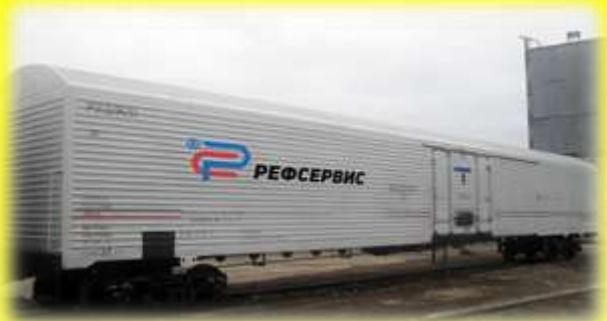
**Изотермический вагон — крытый грузовой вагон для перевозки скоропортящихся грузов.**
