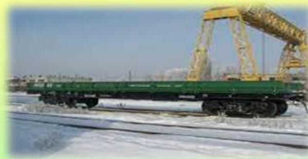
**Платформа — грузовой вагон открытого типа, предназначенный для перевозки длинномерных, штучных грузов, контейнеров и оборудования, не требующих защиты от атмосферных воздействий.**
