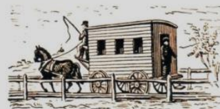
Пассажирский экипаж начала XIX в. на перегоне конной железной дороги
