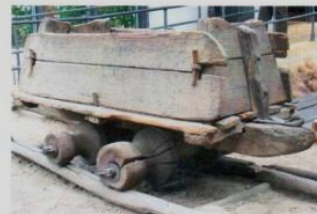
Шахтный деревянный рельсовый путь и вагонетка. XVI в., Немецкий технический музей, Германия
