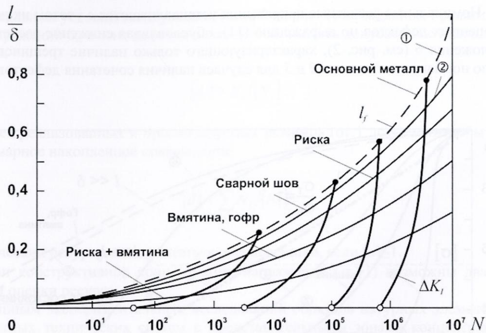
Рис. 3. Кинетические кривые роста трещин при сочетании дефектов
