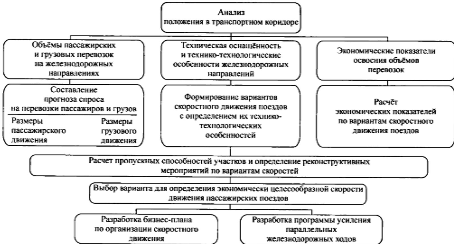
Рис. 1.19. Последовательность действий при оценке вариантов организации скоростного движения поездов на существующих железных дорогах
