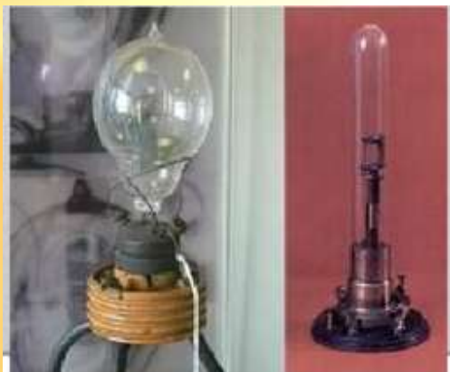
Дуговая лампа Фуко с ручным регулированием длины дуги.
